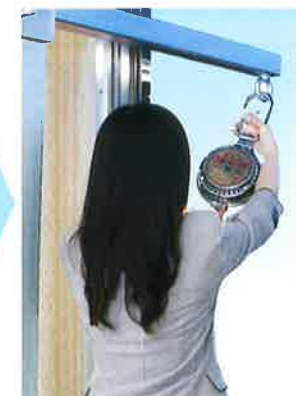
2 安全環を金具の吊環に掛け、止め金具を確実に締め上げる
