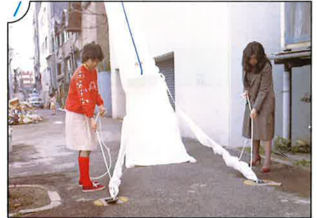
●ハッカーを固定環に引掛け
